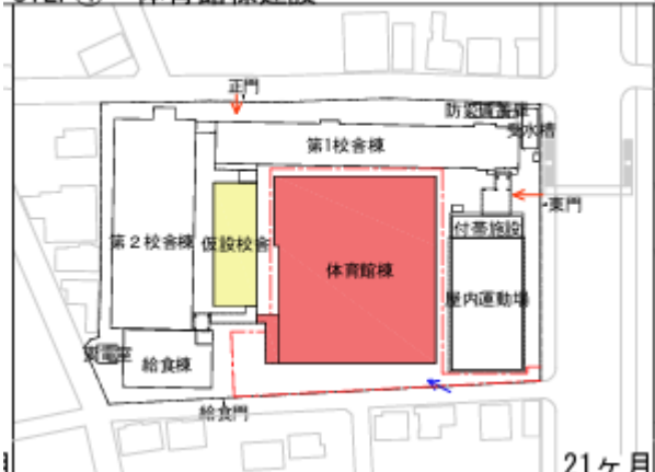
STEP④ 体育館棟建設
