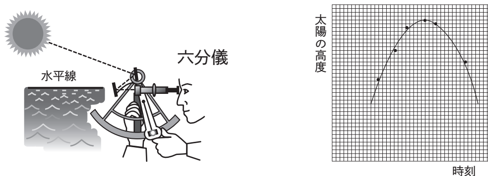
【図8】 六分儀を使った太陽の高度観測と結果例
