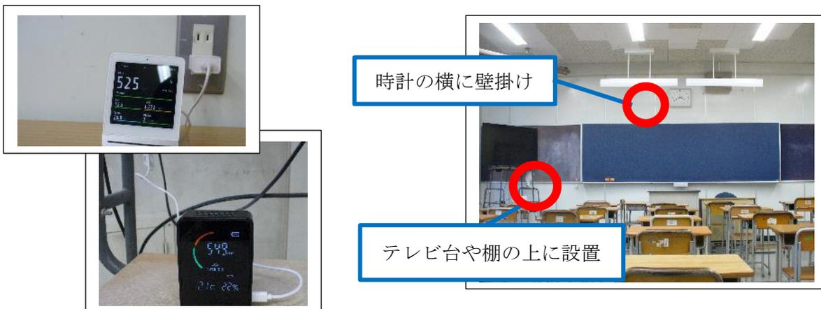
※ CO<sub>2</sub>モニターは、インターネット接続タイプと非接続タイプの2種類のいずれかを各クラスに設置
