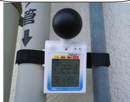
運動場側に設置したWBGT計
